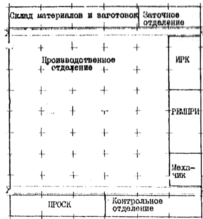
Рис. II. Схема расположения участков механического цеха
